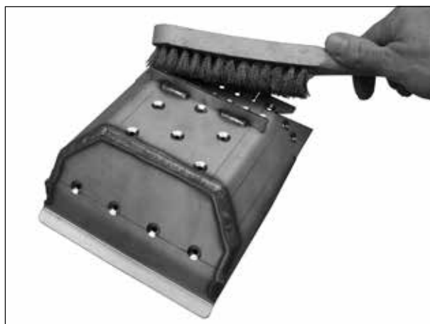
Demonstracja czyszczenia komory spalania palnika
