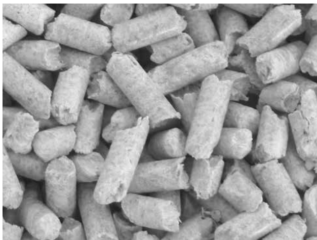
Rys. 17 - pellet wysokiej jakości – białe bez czarnych kropek (kory)
