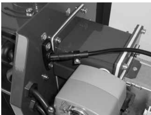
Rys. 6 - fotokomórka - należy uważać na prawidłowy kierunek podłączenia - zaleca się czyszczenie przynajmniej raz w roku
