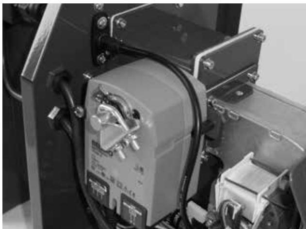
Rys. 11 - specjalna klapka dostępu powietrza z zaworem elektrycznym
