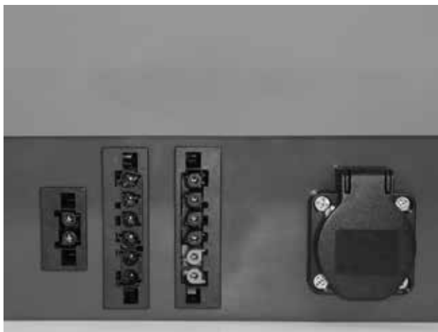
Rys. 12 - palnik z dwoma 6 - pinowymi przyłączami, lewe - zasilanie, prawe - czujniki, 2-pinowe gniazdo dodatkowych przewodów (dla R3 i R4) i gniazdo zasobnika
