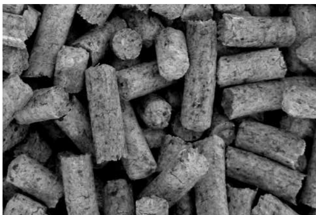
Złej jakości pelety drewniane - ciemne z korą (z czarnymi kropkami)
